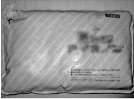
写真1 EG含有タイプの保冷剤 冷凍保存してもゲル状のまま
