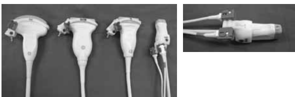
図2 ポジションセンサー対応マルチ用穿刺ホルダを装着したプローブ 2個の磁気センサーによってXYZの位置と軸と回転を検知し、プローブの空間的な位置と向きを検出する。
