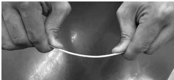
写真1 レバーアームを長くすることで応力を分散できる。
