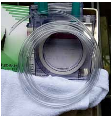
写真1 市販ポリ塩化ビニル製チューブ (左)，挿入側先端を約17°の角度に切断 (右)
